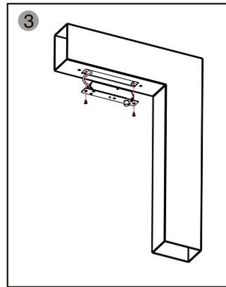
Verdrahtung der Anschlussleitungen durchführen und das SVB501 montieren
