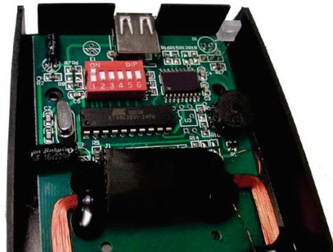
Die interne UID Nummer eines RFID-Transponders kann auf 8 verschiedene Arten ausgelesen werden. Die Einstellung erfolgt über die DIP Schalter auf der Platine. Zum Öffnen des Gehäuses sind die 4 Schrauben unterhalb der Gummifüße zu lösen.
